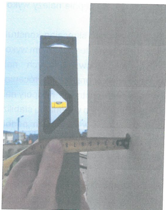
Odchylenie od pionu na wysokości 2m wynosi odpowiednio 6,5cm i 5,5cm
