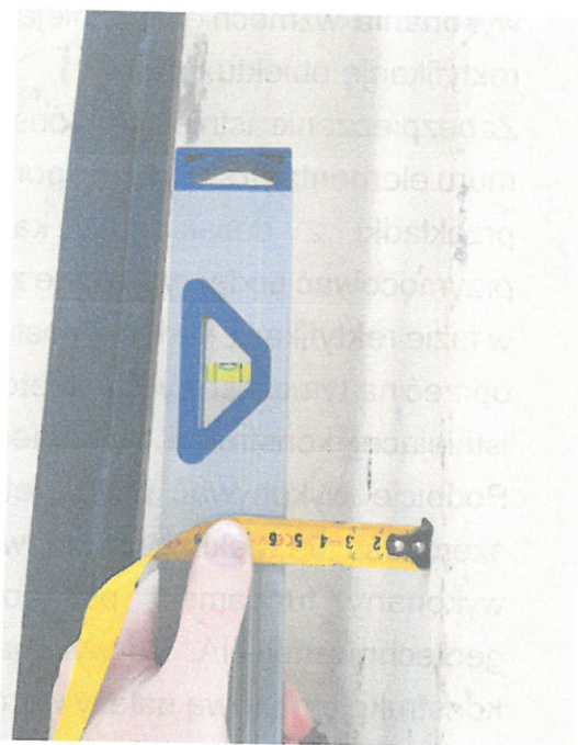
Odchylenie od pionu na wysokości 2m wynosi odpowiednio 6,5cm i 5,5cm
