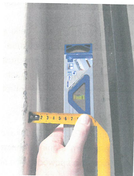
Odchylenie od pionu na wysokości 2m wynosi 5,5cm.
